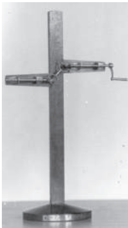
Modell nr 1 från Chalmersska Slöjdeskolan, polhemsknutar, tillverkad av eleven B J Westberg. Modellen var färdigtillverkad 4 månader efter skolans öppnande 1830. Foto: Hans Wallenberg.
